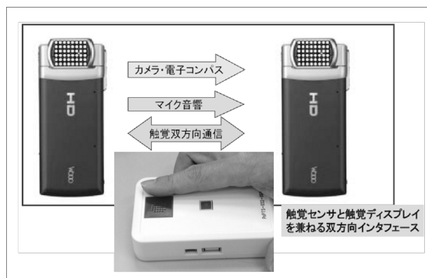
図 4.2.13 カメラ、マイクロホン、触覚センサおよび触覚ディスプレイが一体となった触覚と携帯電話のインターフェース
